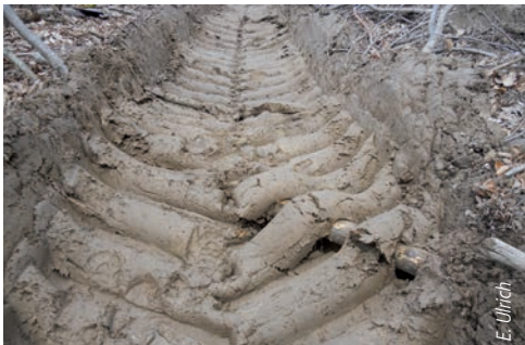
Compactage après 40 passages avec un porteur
