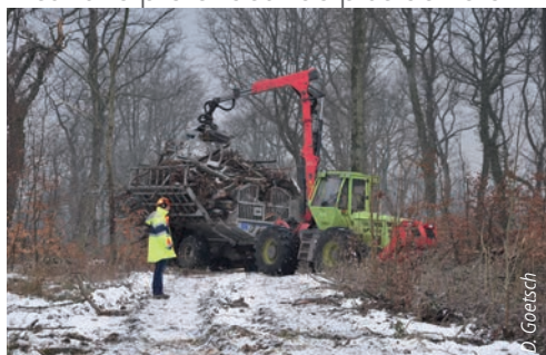
Débardage de gros houppiers feuillus avec un porteur sur sol gelé depuis 10 jours
