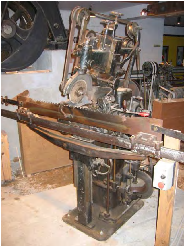
Photo 105 : affûtage des lames de haut fer.
