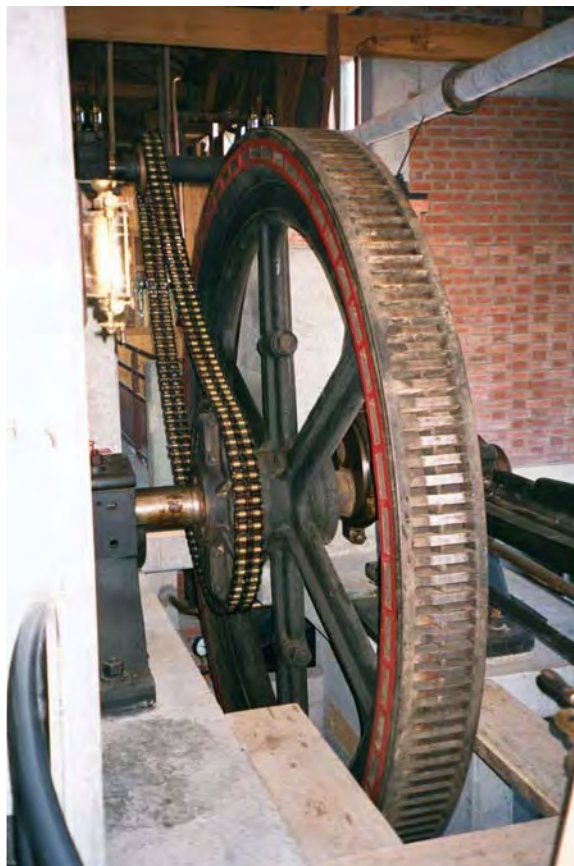
Photo 104 : la machine à vapeur, modèle Corliss de 1896.
